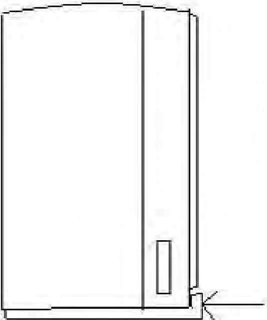
**2,5 mm Loch bohren und den Gummi hier abwinkeln. Dazu einen kleinen Keil herausschneiden, damit das Abwinkeln möglich ist.**
